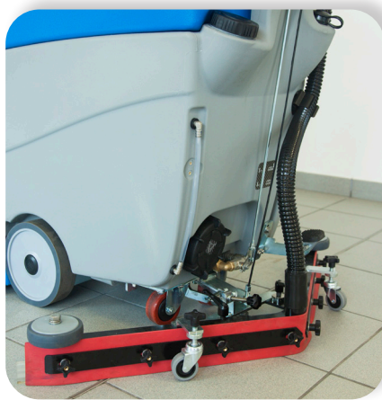
lo squeegee oscillante segue il movimento della macchina
