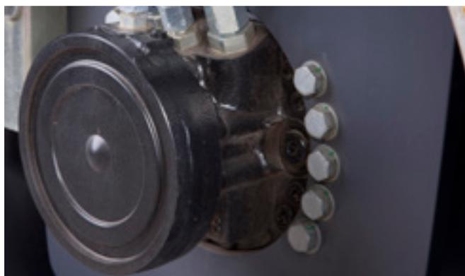
Freni di sicurezza su entrambi i tamburi (o tamburo e gomme) che si attivano automaticamente in caso di guasto al motore o al circuito idraulico/elettrico
