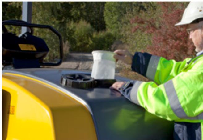
Il serbatoio acqua ha un'ampia apertura per facilitare il rifornimento
