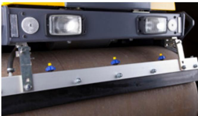
3 ugelli di spruzzatura su tutti i mod. CC1100-CC1300. 3 filtri assicurano acqua pulita. Il timer di spruzzatura è standard sul Dynapac CC1300 e su tutte le versioni PLUS.
