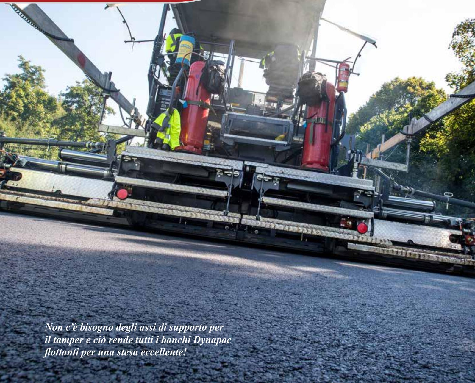
*Non c'è bisogno degli assi di supporto per il tamper e ciò rende tutti i banchi Dynapac flottanti per una stesa eccellente!*
