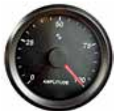
Quando il peso variabile (2) viene ruotato fino alla posizione mostrata in figura, l'ampiezza è del 100%.
